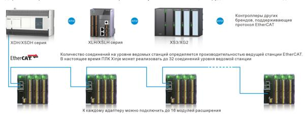
\*Примечание: При подключении следуйте принципу снизу - вход, сверху - выход.
