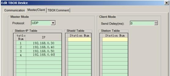
T-BOX3 parameters setting: (turn on DIP switch 1)
