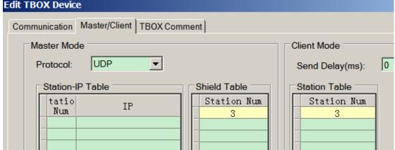
T-BOX6 parameters setting: (turn on DIP switch 1)
